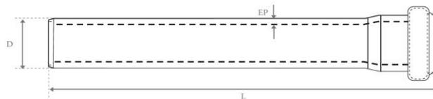
**TUBE PVC A JOINT PN6 POUR FORAGE****Domaine d'application**
